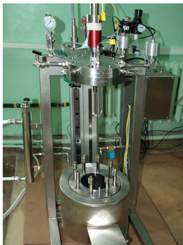
Рис. 3.26. Общий вид автоклава перед загрузкой образцов
