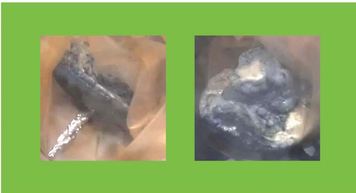
Рис. 3.30. Внешний вид фильтрата (регенерированного цинкового сплава) для повторного использования в процессе снятия оболочек
