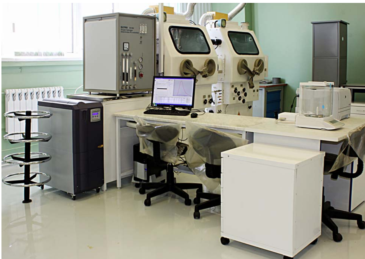
Рис. 3.27. Внешний вид установки газового анализа с газоанализатором ELTRA-OH-900
