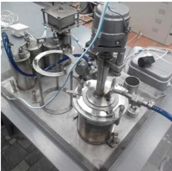
Рис. 3.16. Внешний вид установок для термодеструкции (а) и сварки мишеней (б) участка изготовления мишеней-накопителей трансплутониевых элементов
