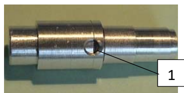
Рисунок 2 – Кондуктор для сборки и сварки. 1 - смотровое окно
