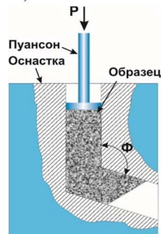
Рис. 2. Схема установки для равноканального углового прессования
