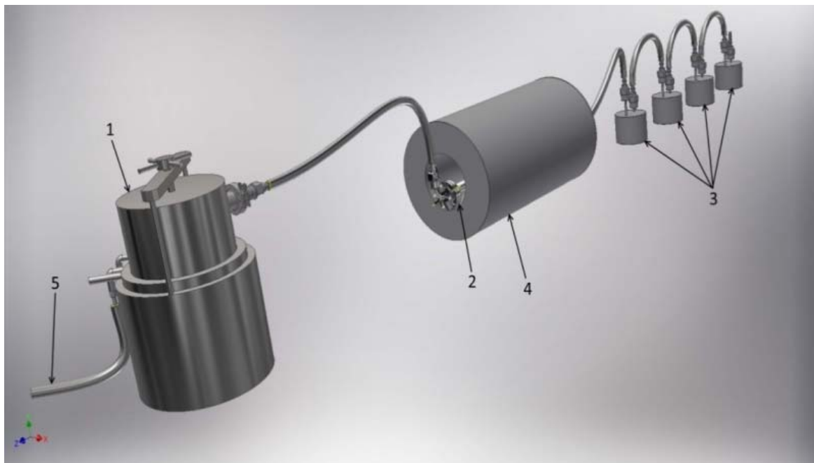
Рисунок 1 - Схема установки для проведения экспериментов по волоксации СНУП ОЯТ: 1 – Аппарат окисления; 2 – колонка с сорбентом; 3 – каскад барботеров; 4 - печь проходная; 5 – линия подачи газов в реакционную камеру АТВО
